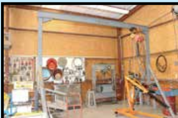
1 T. ROLLING A-FRAME GANTRY CRANE
