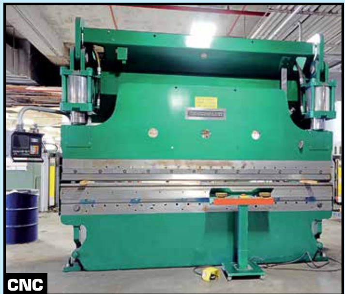
CINCINNATI 230 T. X 12' HYD. PRESS BRAKE
