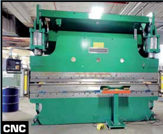
CINCINNATI 230 T. X 12' HYD. PRESS BRAKE
